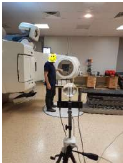
а) Установка ионизационной камеры и УДКГ-37 в пучок ускорителя
