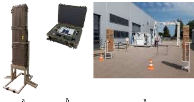
Рис. 3. Установка радиационного контроля УРК-АТ6110: а) измеритель УРК-АТ6110; б) планшетный ПК; в) УРК-АТ6110 в эксплуатации
