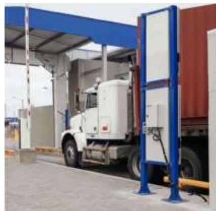
Рис. 1. Установка радиационного контроля УРК-АТ2329
