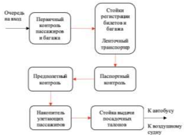
Рис. 1. Схема обслуживания пассажиров при вылете в аэропорту
