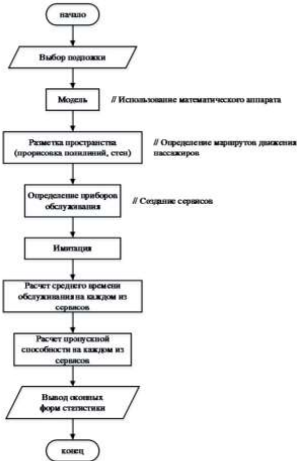
Рис. 3. Алгоритм работы модели цифрового двойника аэровокзального комплекса
