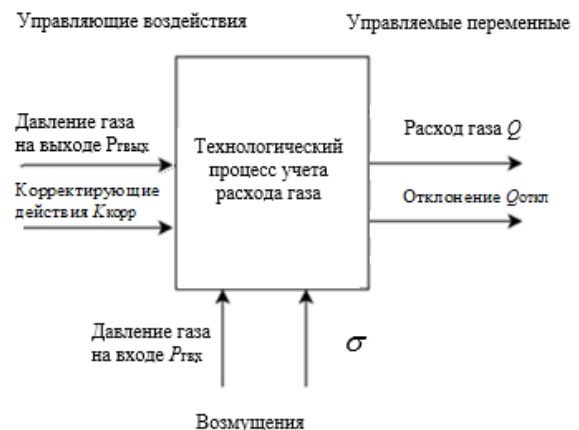
Рис. 3. Процесс учета расхода газа на основе дискретного автомата
